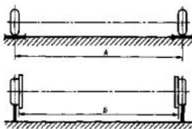
Трансформаторы массой менее 200 т
